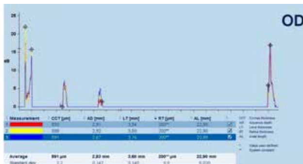
Figura 1: grafico della biometria ottica. Ogni picco nel grafico rappresenta un diottero: superficie anteriore e posteriore della cornea, superficie anteriore e posteriore del cristallino e superficie anteriore e posteriore della retina (Lenstar 900, Haag-Streit)
