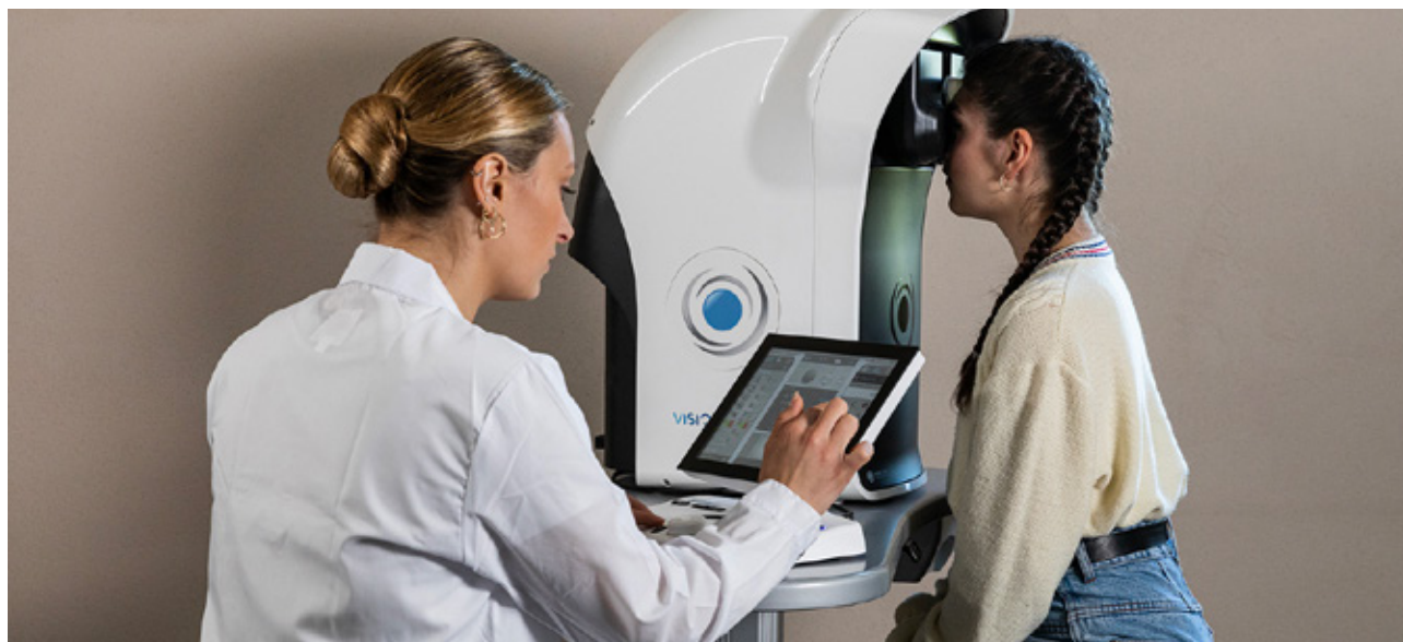
Fig. 1: nelle unità di refrazione compatte un sistema ottico proietta la mira all'infinito e la misura avviene in campo chiuso.
