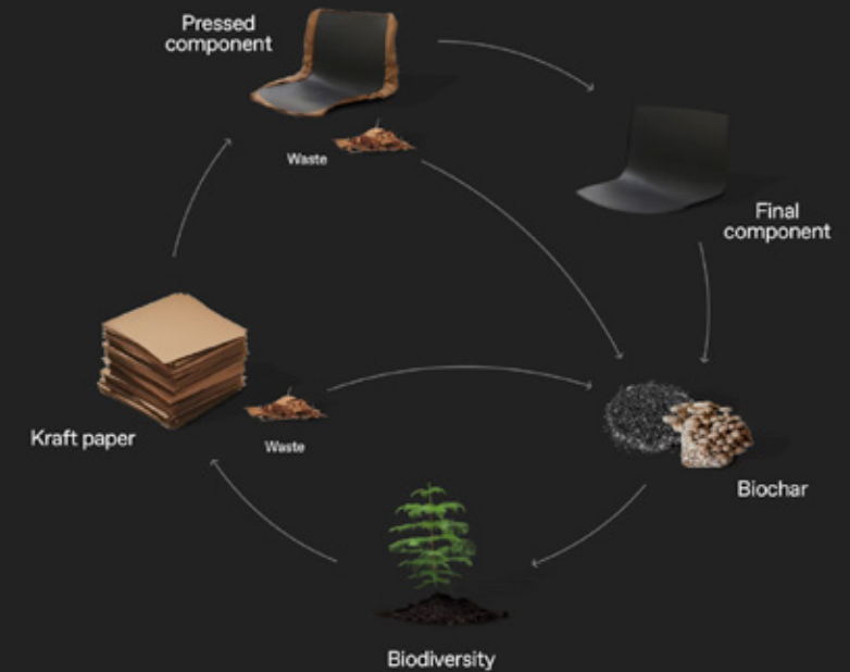
Ciclo PaperShell: in fogli di cellulosa pressati nella forma desiderata. A fine vita il materiale è processato con pirolisi (riscaldamento in assenza di ossigeno) per creare il biochar, carbone vegetale con funzione di concime organico. Courtesy PaperShell.
